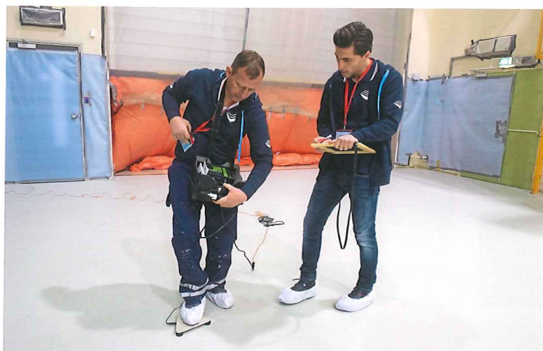
Überprüfung der neuen ESD-Bodenbeschichtung im Forschungszentrum der ESA mit Dreifußelektrode und Widerstandsmessgerät.
